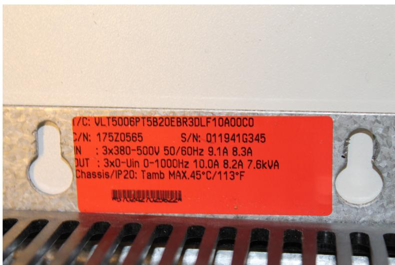
Typenschild des Danfoss Frequenzumrichters VLT 5006
