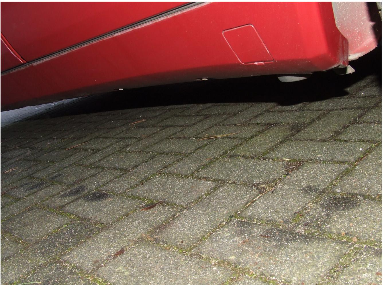
Bild 19: Schwellerbereich links - selbst die kritischen Punkte für die Aufnahme des Wagenhebers ohne Befund!
