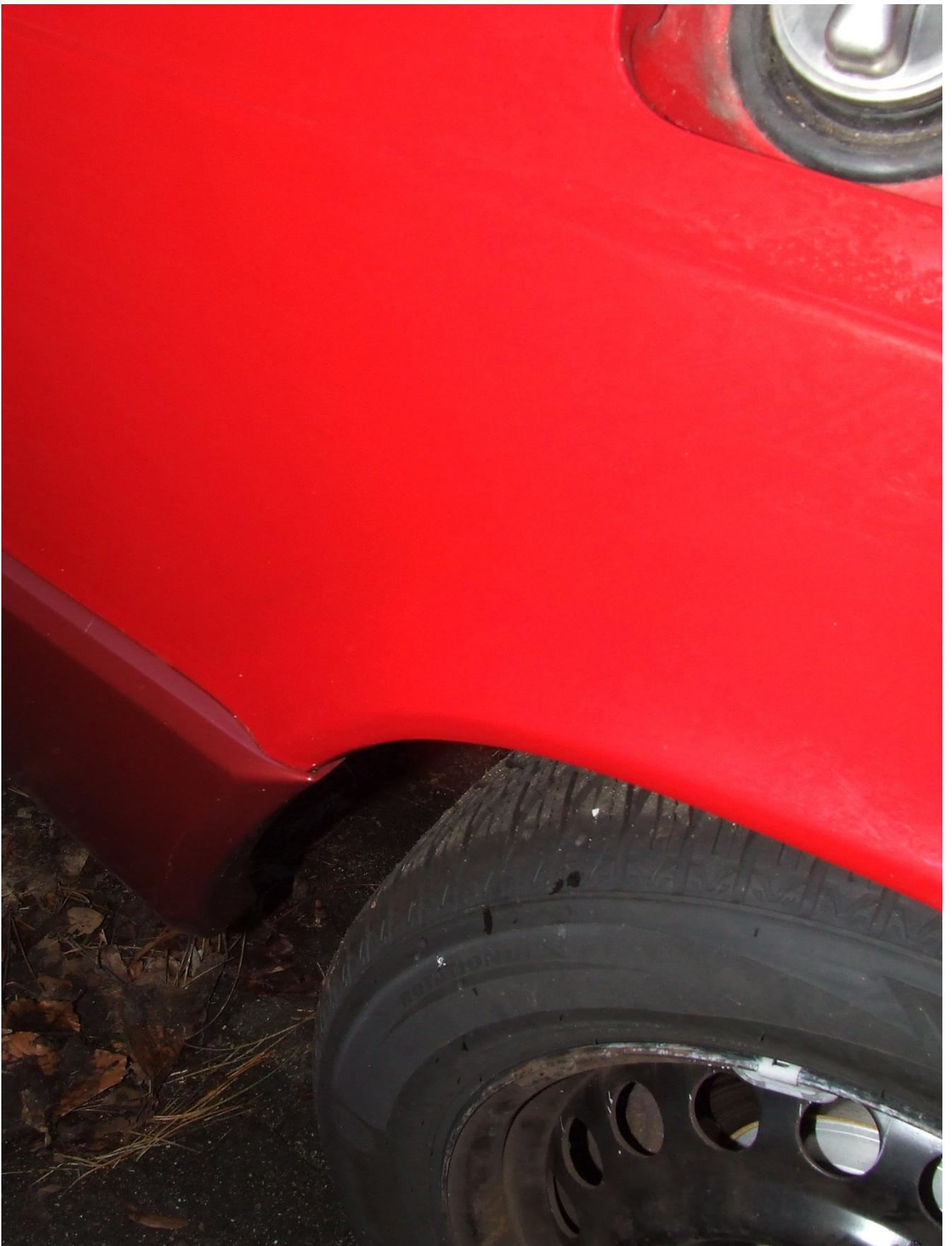
Bild 10: Seitenbereich hinten rechts unterhalb des Tankdeckels - korrosionsfrei!
